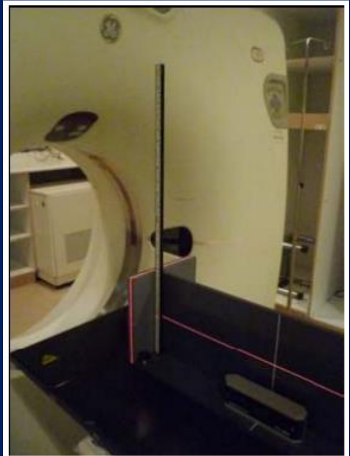
圖十四、尺直立於檢查床上，設定兩側雷射向上及向下各移動固定距離。
