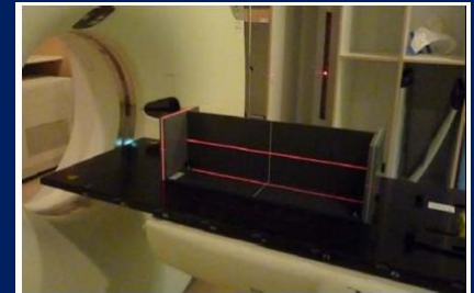
圖九、在多平面的不同位置皆內含兩個以上直徑 2 毫米圓形孔洞的測試假體。
