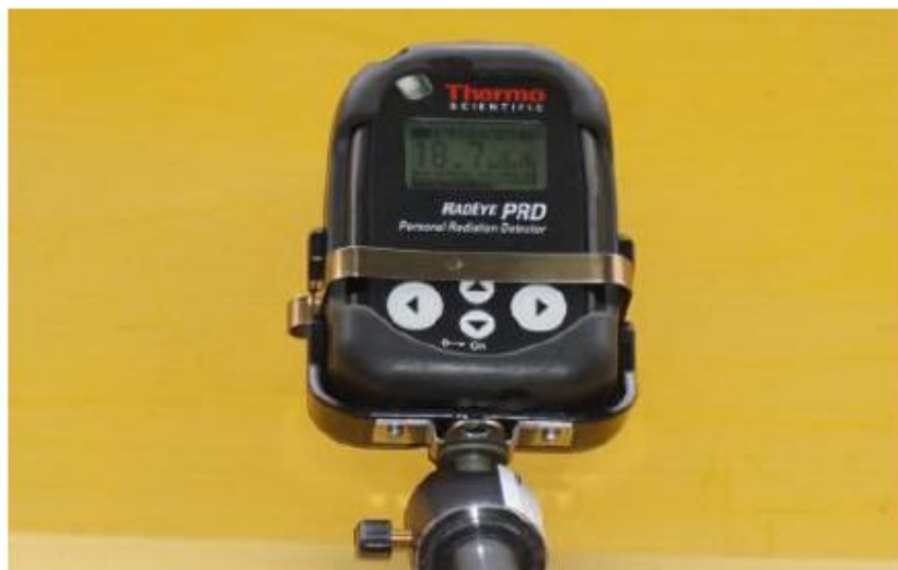
垃圾車一側表面劑量率最高值為 18.7\mu\text{Sv/h}
